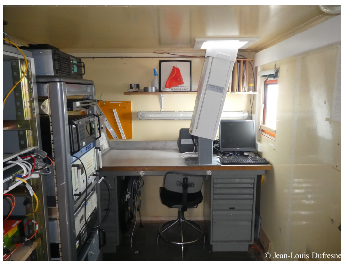
FIGURE 2 – Ceilomètre déployé à DDU dans l'abri Chantal, visant le ciel à travers un hublot dans le toit.
